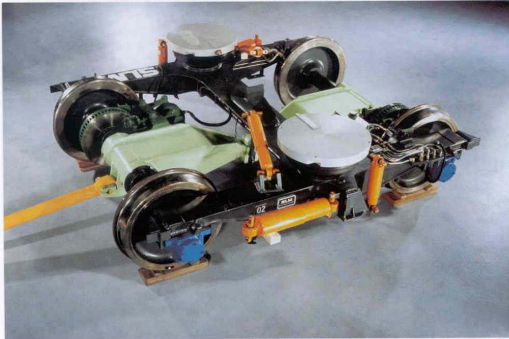
zwei Luftfedern mit integrierter Notfederung plaziert. Die spezielle Ausführung des Drehgestellrahmens hat die Eigenschaft einer Wankstütze in der Primärfederstufe, was eine zusätzliche Wankstütze in der Luftfederstufe mit den bekannt negativen Auswirkungen auf die Körperschallübertragung überflüssig macht.
